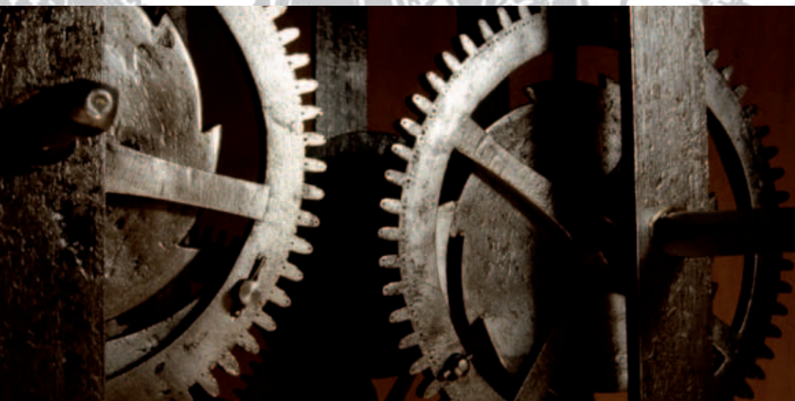
Rouages du XVIIIe en fer, divisés et façonnés à la main
